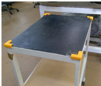
養生材(1)、(2)を使用する 場合は、作業台角部にコー ナークッションをセットする
